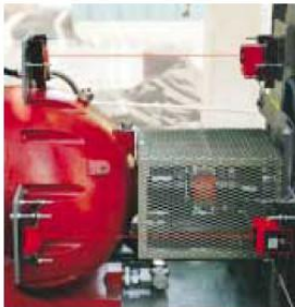
PERMALIGN® – непрерывный мониторинг центровки
