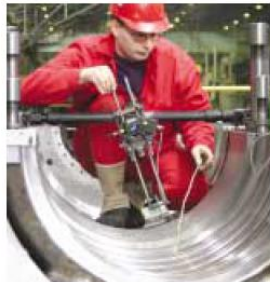
BORALIGN® и CENTRALIGN® – центровка отверстий и турбин
