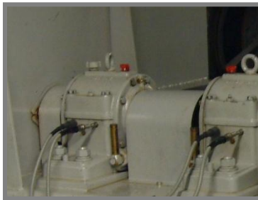
Сенсоры на картере вентилятора
